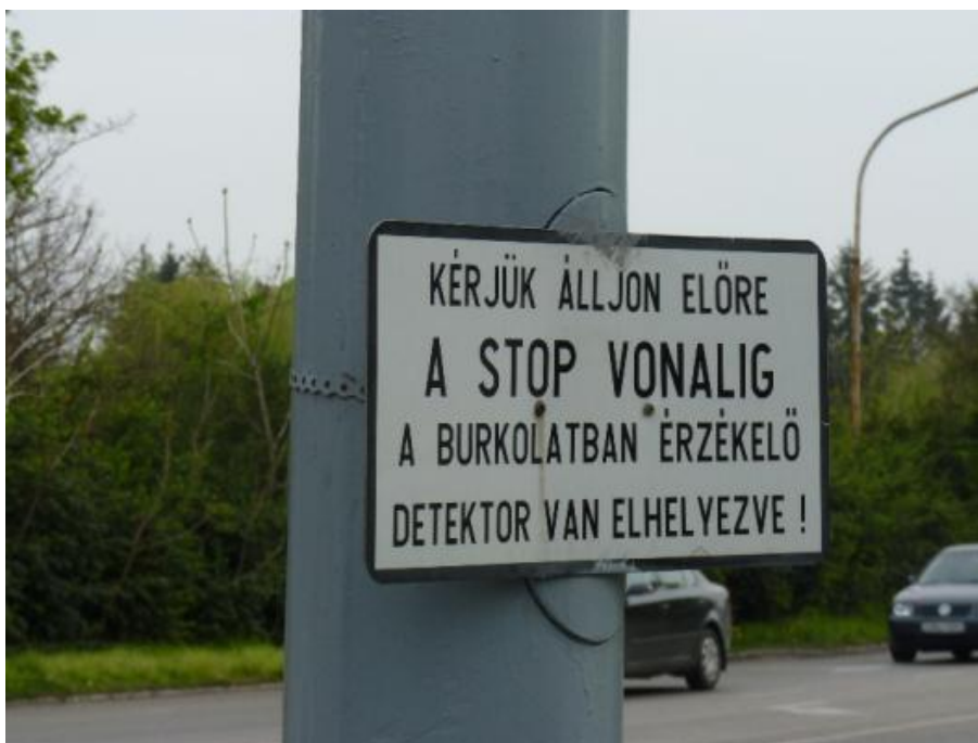
45. ábra: Detektoros jelzőlámpa a Dr. Csányi László krt. - Budapesti főút - Zöldfa utca csomópontban: a kerékpárosokat a detektor nem feltétlen észleli
