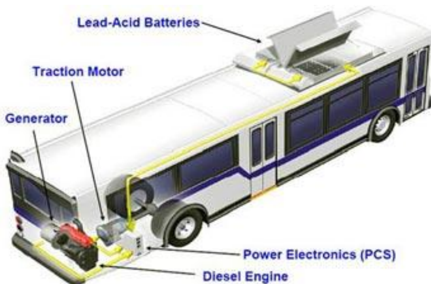
73. ábra: Példa a dízel-elektromos hibrid busz felépítésére (Forrás: http://puregreencars.com/files/Orion-VII-hybrid-bus.jpg )
