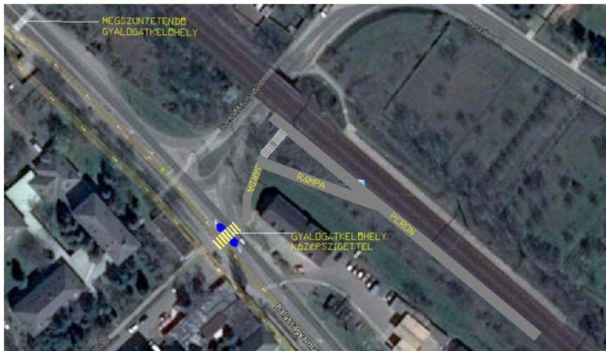
30. ábra: Kisvác vasúti megállóhely kiszolgálásának fejlesztése
