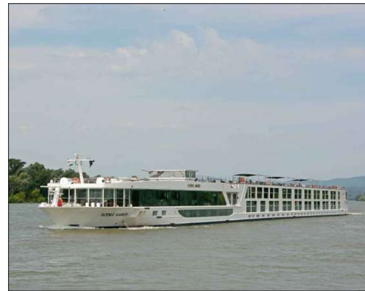
2. Folyami szállodahajó (L=135 m, B=11,45 m, D=2 m)
