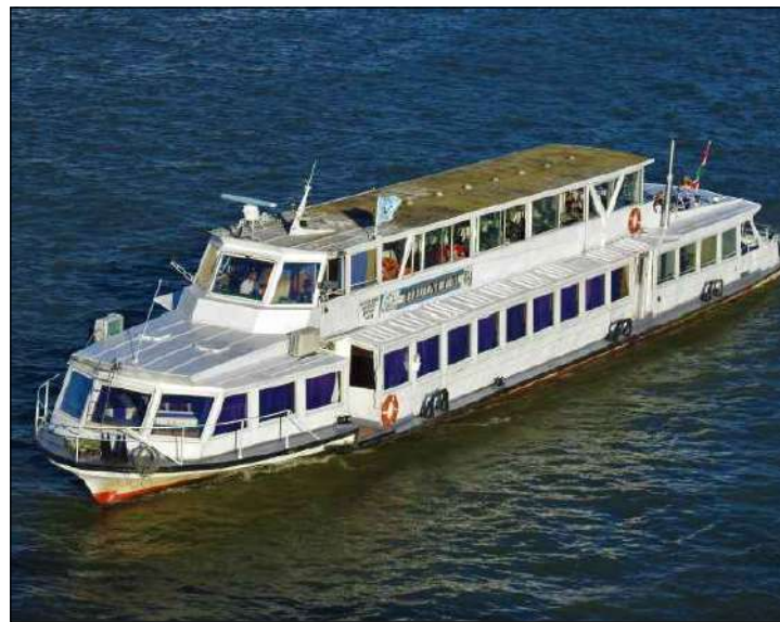
1. Moszkva-típusú járáshajó (L=38,2 m, B=6,1 m, D=1,1 m)
