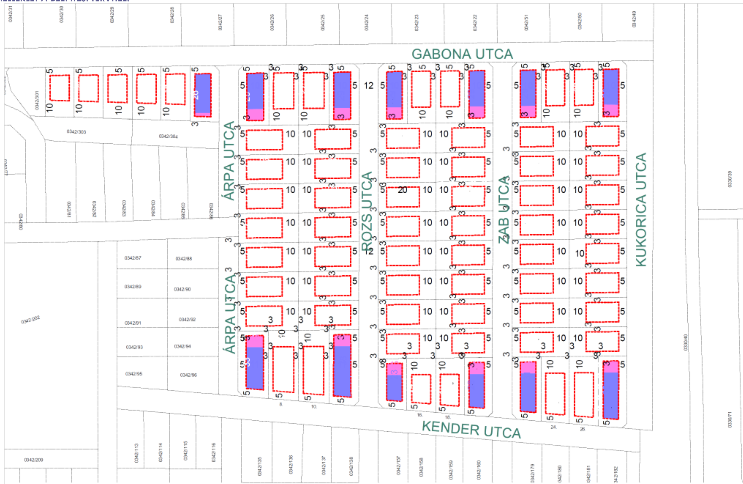
A hatályos szabályozás (kék kitöltés) és a beépíteni kívánt építési helyek (kék+rózsaszín kitöltés) különbsége Piros szaggatott kontúr: tervezett építési helyek
