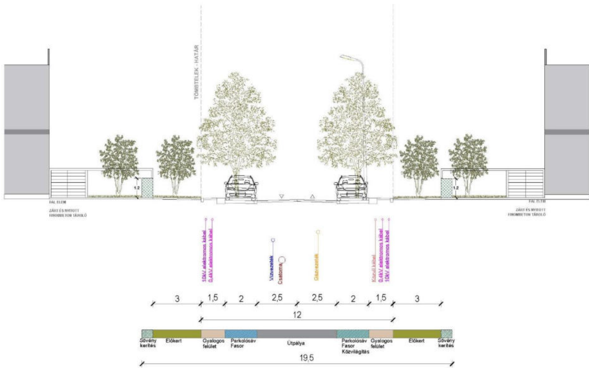
12 m-es szabályozási szélességű kiszolgáló út keresztmetszete
