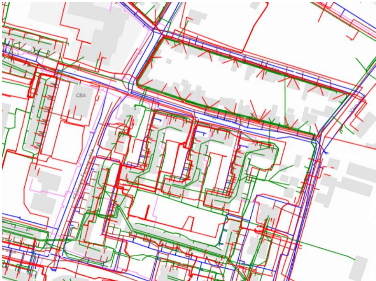
A vizsgált tömb közműellátottsága (piros: villamos energia, kék: ivóvíz, zöld: hírközlés, barna: vízvezetés) /forrás: e-közmű adatszolgáltatás/
