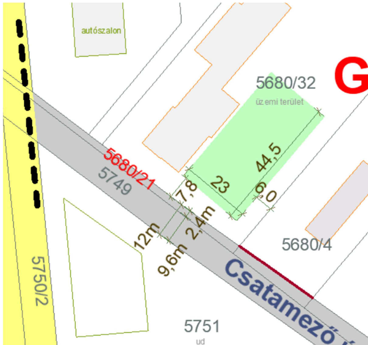
Szabályozási javaslat 1.0 részlet: a Csatamező út szélesítése – a hatályos szabályozás megtartása – 12 méterre
